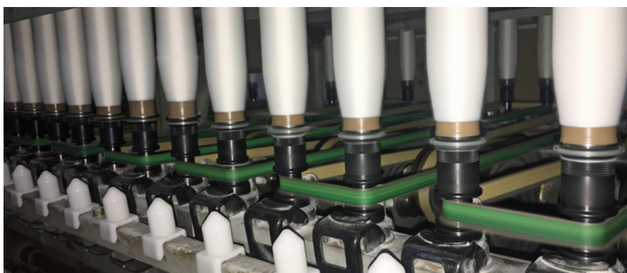
LENA со стандартным режущим элементом Novibra на машине
