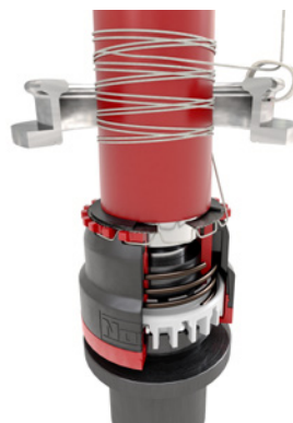
装新纱管 夹住纱线 锭子启动.
