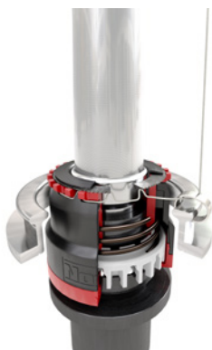
锭子停止 夹住纱线 拔下纱管 切割纱线.
